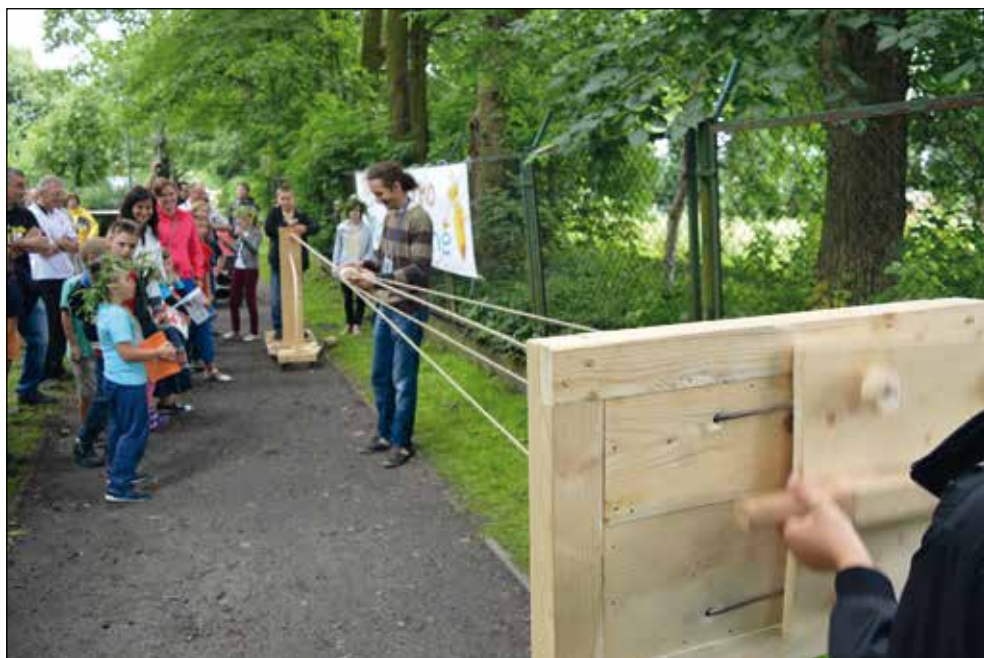
Ryc. 16. Miasteczko Edukacyjne podczas festynu historycznego, wykonanie liny przy użyciu powroźnicy. Fot. S. Preiss, MAH w Stargardzie
